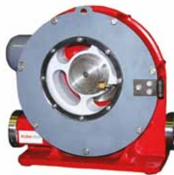
Kampiakselilla varustetussa letkupumpussa on epäkeskeinen rulla, joka puristaa letkun vain kerran jokaisen 360 asteen kierroksen aikana.
